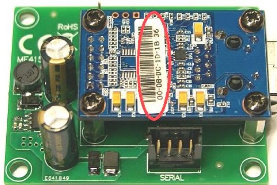
Obr. 5. Umístění adresy MAC na modulu převodníku INTE.
