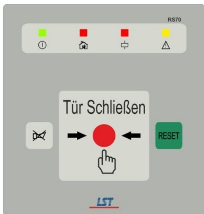
Ukazatele a ovládací tlačítka na přední straně kouřového spínače RS70
