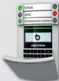
При снятии сигнализации с охраны с помощью кнопок сегмента авторизация пользователя всегда обязательна. При постановке сигнализации на охрану и управлении автоматическими процессами при помощи кнопок сегментов авторизация пользователя не обязательна.
