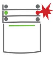
3. Завершается снятие с охраны, и сирены выключаются. Мигающая зеленым светом кнопка указывает на снятие с охраны конкретного раздела. Мигающий красным свет указывает на память сигналов тревоги.
