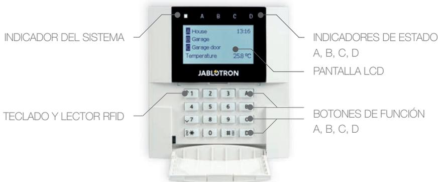
Los estados de cada partición individual son indicados por los indicadores de estado A, B, C, D sobre el display LCD y los botones de función. El panel de control se puede manejar directamente (armar o desarmar la alarma y otras funciones de automatización) utilizando los botones de función del teclado. Los botones de función y los indicadores de estado A, B, C, D están retroiluminados para indicar claramente el estado de la partición.
