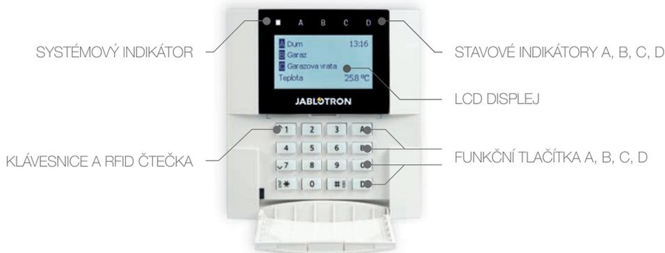
Stav jednotlivých sekcí je indikován stavovými indikátory A, B, C, D nad LCD displejem a funkčními tlačítky. Vlastní ovládání (odjištění nebo zajištění systému a další funkce automatizace) se provádí pomocí funkčních tlačítek. Funkční tlačítka sekcí a stavové indikátory (A, B, C, D) jsou barevně prosvětleny tak, aby byl na první pohled zřetelně indikován stav sekcí.
