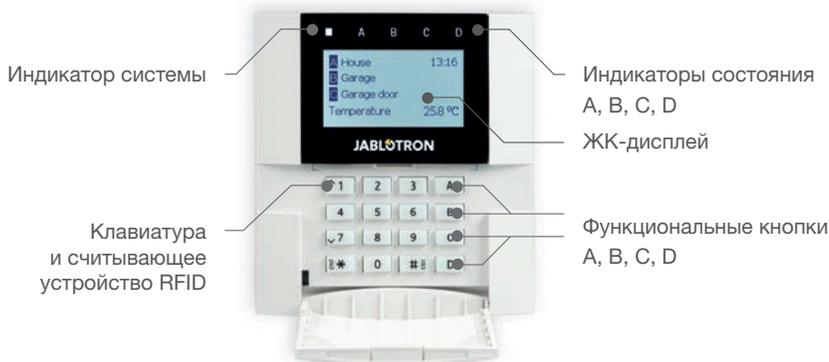
Состояния отдельных разделов указываются индикаторами состояния А, В, С, D над ЖК-дисплеем и функциональными кнопками. Панель управления может управляться напрямую (постановка на охрану и снятие с охраны, а также другие автоматические функции) с помощью функциональных кнопок на клавиатуре. Функциональные кнопки и индикаторы состояния А, В, С, D имеют цветовую подсветку, чтобы четко различать состояние раздела.
