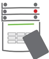
**1. En entrant dans le bâtiment** (déclenchement d'un détecteur avec une réaction « Zone temporisée »), le système commence à signaler la temporisation d'entrée par une tonalité continue et le clignotement de la touche verte du segment
