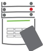
**1. Cuando entra en un edificio** (activando un detector con reaccion "Zona retrasada"), el sistema empieza a indicar el retraso de entrada con un tono continuo y parpadeo del boton verde del segmento que tiene esa particion asociada, en la
