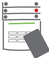
1. При входе в здание (сработает датчик с реагированием «Зона с задержкой»), система включает индикацию задержки для входа: непрерывный звуковой сигнал и мигание зеленым
