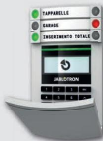
Quando si disinserisce l'allarme utilizzando i pulsanti del rispettivo segmento, viene sempre richiesta l'autorizzazione utente. Quando si imposta l'allarme e durante la gestione dei processi automatizzati mediante i pulsanti dei segmenti, l'autorizzazione utente è invece facoltativa per ciascun singolo segmento.
