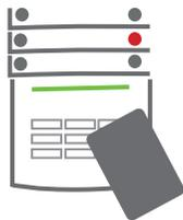
1. All'entrata nell'edificio (con innescato di un rilevatore con reazione «zona ritardata»), il sistema si avvia indicando il ritardo entrata, emettendo un suono fisso e facendo lampeggiare in verde il pulsante segmento della sezione in cui l'entrata
