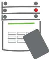
1. Wenn Sie das Gebäude betreten (Auslösung des Melders mit der Reaktion „Verzögerte Zone“), signalisiert das System die Eingangsverzögerung mit einem Dauerton und die Bereichstaste des Sicherheitsbereiches, in dem der verzögerte
