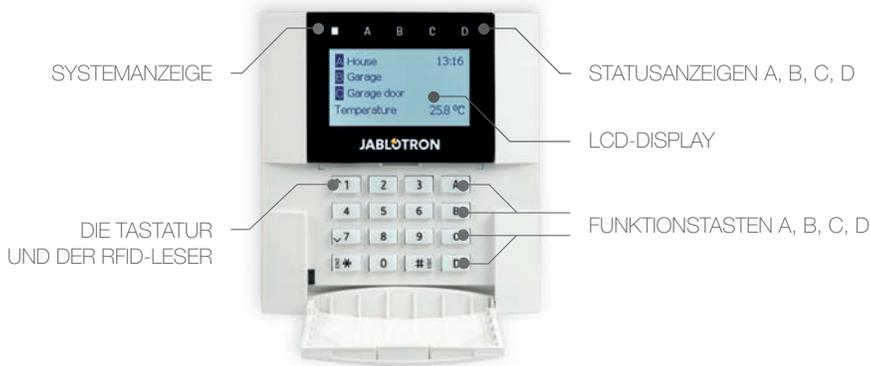
Der Status der einzelnen Bereiche wird durch die Statusanzeigen A, B, C, D über dem LCD-Display und durch die Funktionstasten angezeigt. Die Zentrale kann direkt gesteuert werden (Scharf- oder Unscharfschaltung des Alarms und andere Automatisierungsfunktionen), indem man die Funktionstasten auf der Tastatur verwendet. Die Funktionstasten und die Statusanzeigen A, B, C, D sind farbig hinterleuchtet, um den Bereichsstatus deutlich anzuzeigen.
